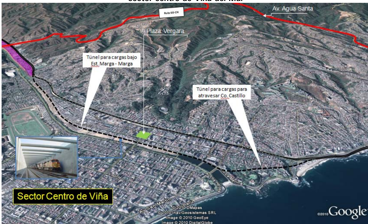
Figura 8. Recuperación y mejoramiento estratégico del ferrocarril de carga en Valparaíso: sector centro de Viña del Mar
