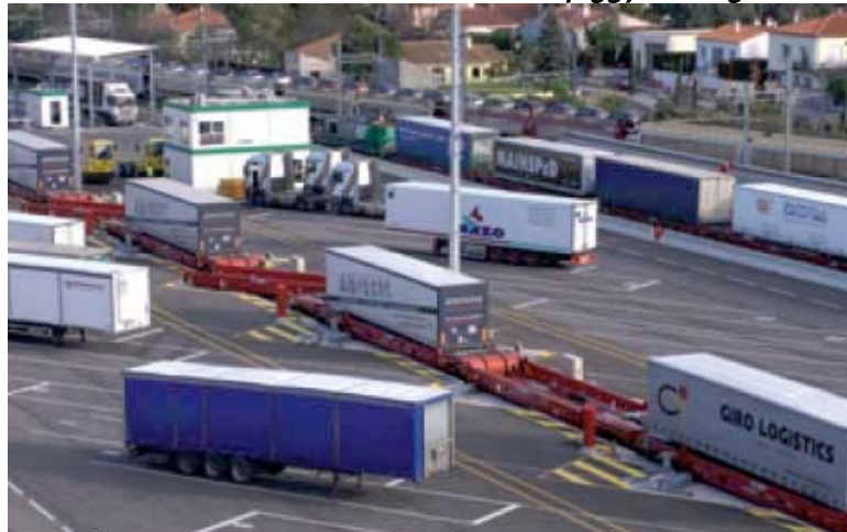
Figura 2-8. Estación intermodal con sistema piggybacking , en Francia
