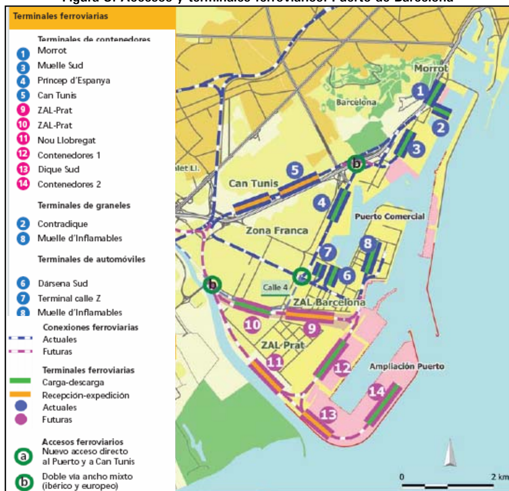
Figura 3. Accesos y terminales ferroviarias: Puerto de Barcelona
