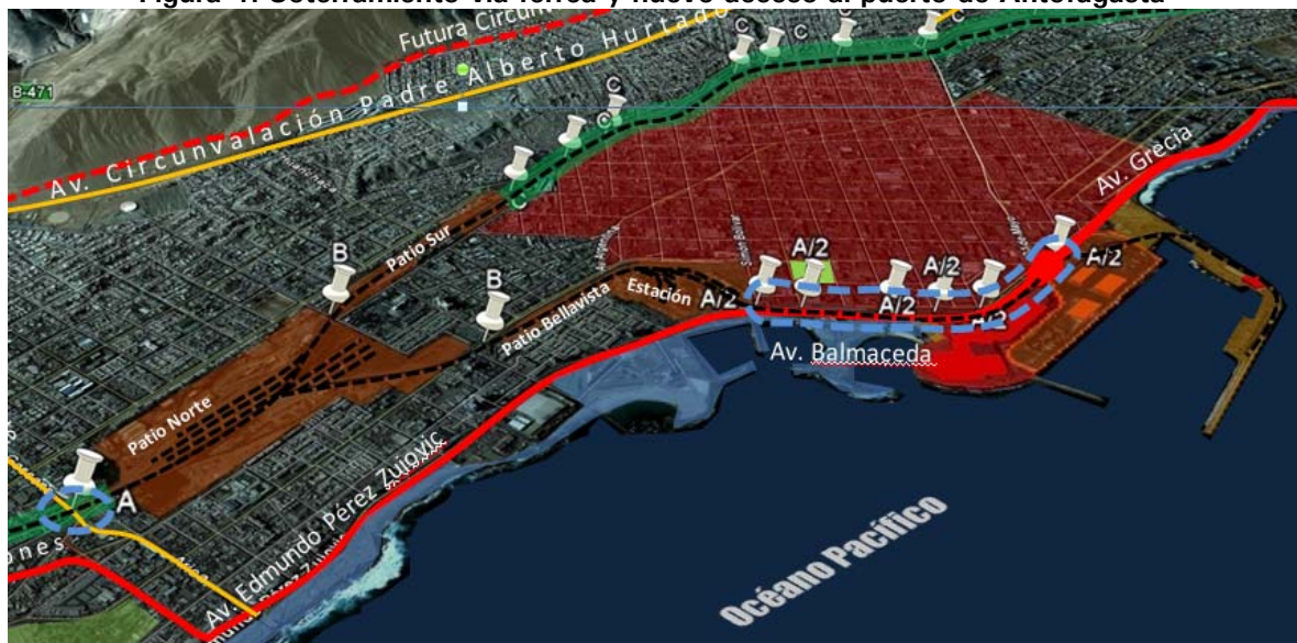
Figura 4. Soterramiento vía férrea y nuevo acceso al puerto de Antofagasta
